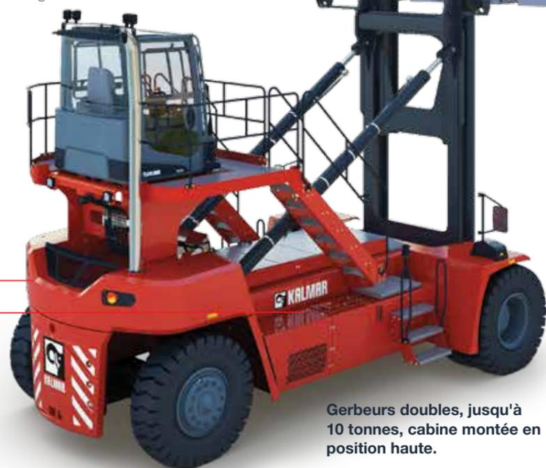
**Gerbeurs doubles, jusqu'à 10 tonnes, cabine montée en position haute.**
