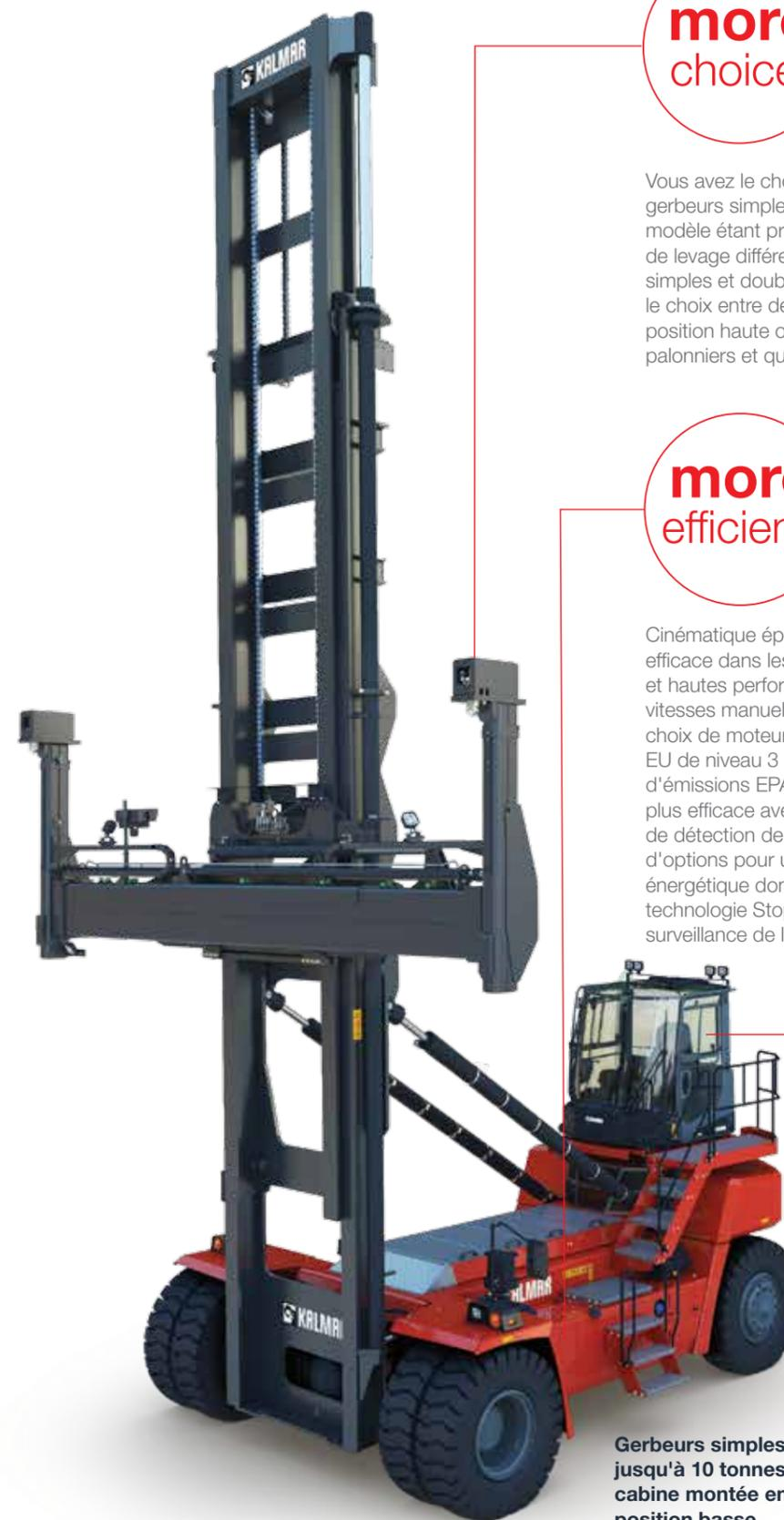
**Gerbeurs simples, jusqu'à 10 tonnes, cabine montée en position basse.**
